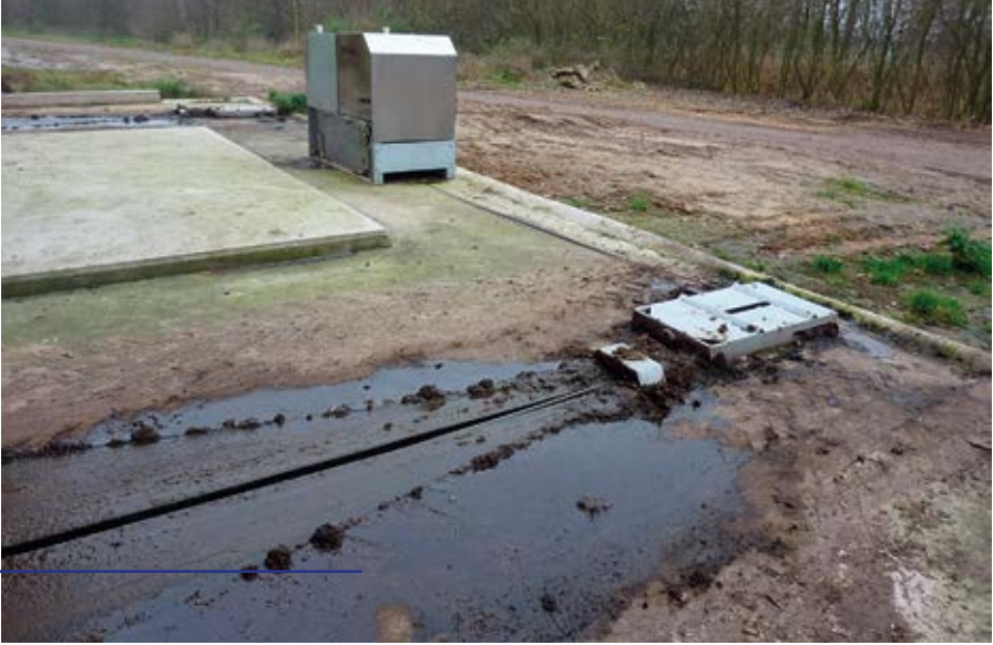
Vaijerilannanpoistokoneen koneikko ja kulmapyörät. Kuva ulkomailta.
