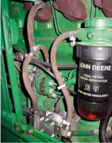
Kuva 4. Lämpivirtausmittarin (CKPT) asennusesimerkki. Ruiskutus-suuttimien ohivirtaus, jota ei näy kuvassa, on johdettu suoraan tankkiin.
