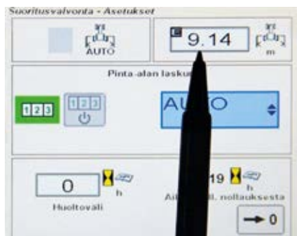
Kuva 9. Vasemmassa valikkoikkunassa on näkyvissä traktorin kulutuslukema-näytöt. Oikeassa valikkoikkunassa kynän kärki osoittaa työlevyden syöttötilaa.
