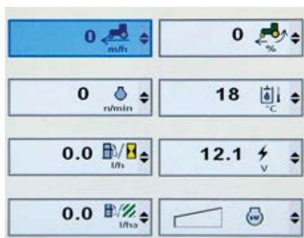
Kuva 9. Vasemmassa valikkoikkunassa on näkyvissä traktorin kulutuslukema-näytöt. Oikeassa valikkoikkunassa kynän kärki osoittaa työlevyden syöttötilaa.
