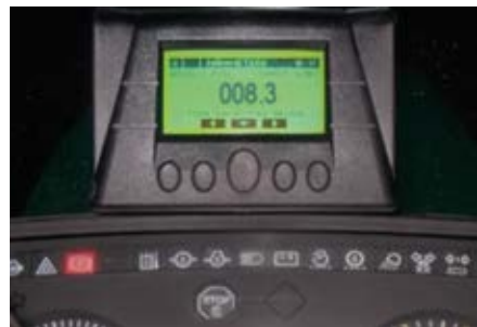
Kuva 6. Kuvan 4. läpivirtausmittarista traktorin kojetauluun yhdistetty näyttö ja tiedonkeruulaite (Esala 2012).
